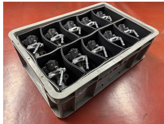
アルミダイカスト製品用通い箱仕切り体
